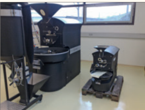
De W15 met daarnaast een zgn. 'ontstener'. Bonen met steentjes zijn funest voor koffiemaal machines.
