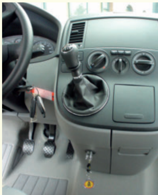
De BearLock'Gentlelock®, de meest toegepaste uitvoering met een inwendige pin, in een VW T5.
